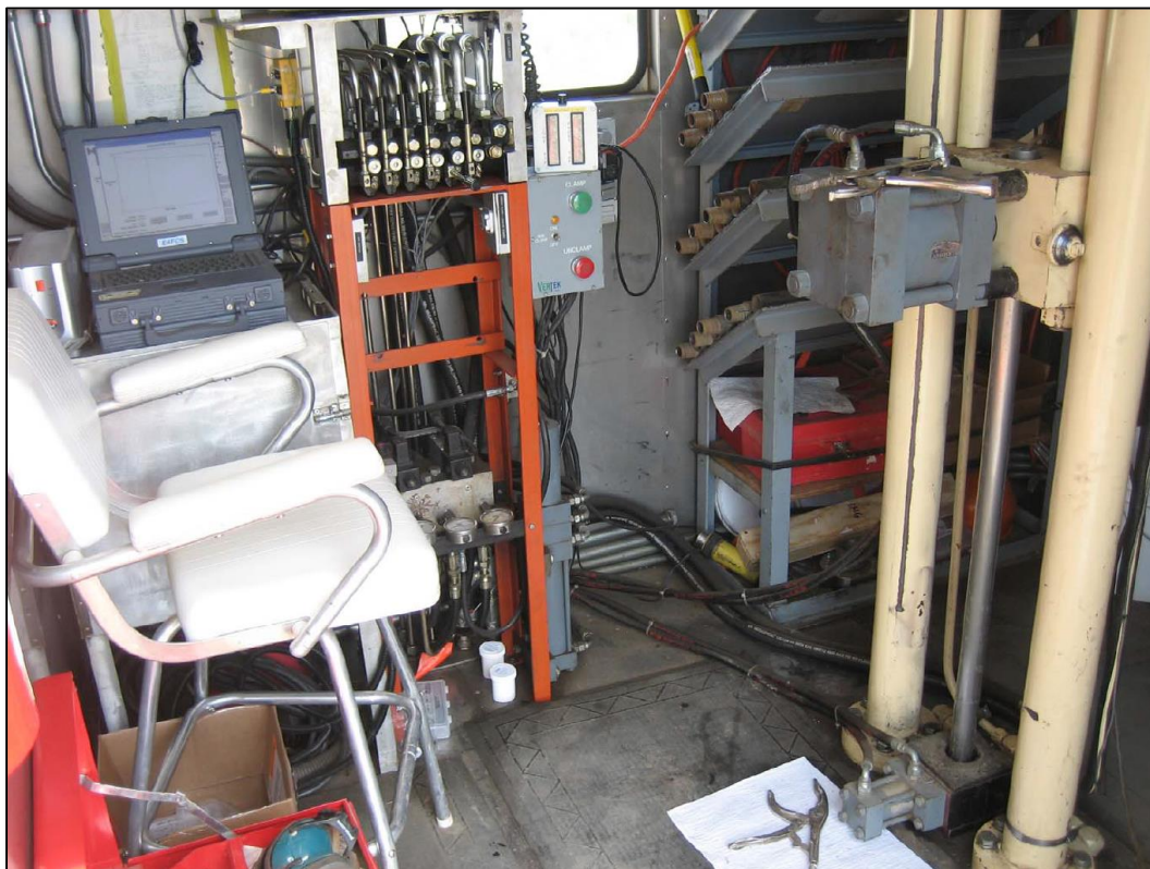
شکل ۸: اتاق کنترل و ثبت داده‌های CPT
