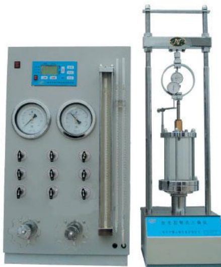
شکل ۴: دستگاه آزمایش سه محوری و تجهیزات مربوط به آن
