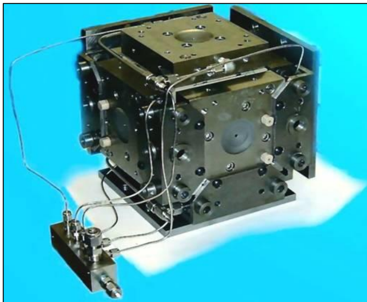
شکل ۸: باکس آزمایش سه محوری واقعی
