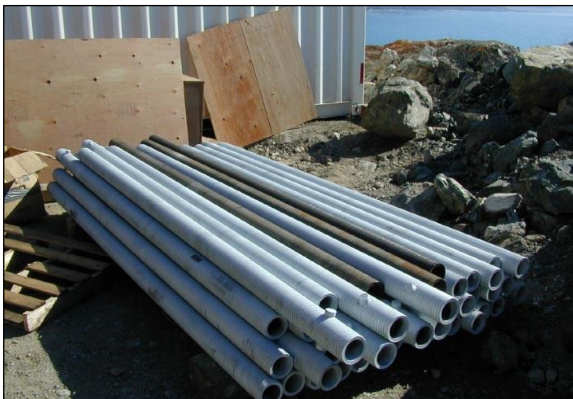
شکل ۹: غلاف‌های مورد استفاده در انکراژ
