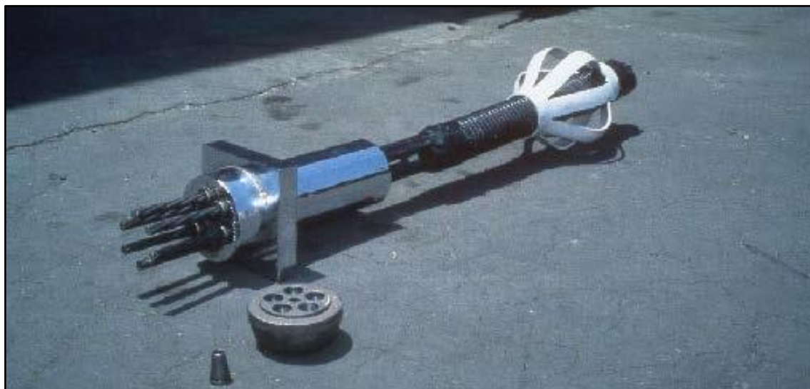
شکل ۱۰: سنتر لایزر نشب شده بر روی یک تاندون کابلی
